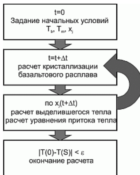
Рис. 1. Блок-схема программы для численного моделирования кристаллизации глобулы с учётом теплообмена с окружающей магмой. Обозначения: T_b и T_m - температуры базальтов и риолитов, x_j - состав базальтов, t - время.
